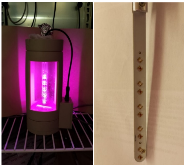
Figuur 7 De 1 liter reactoren met rode en blauwe LED's (Uit: van Dijk et al, 2016)
